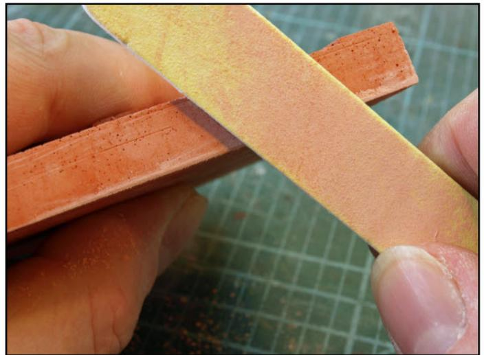
Evtl. Gußgrade werden weggeschliffen. Durch Lufteinschlüsse beim Gießvorgang entstandene „Einschußlöcher“ können mit Spachtelgips gefüllt werden. (Wir haben aber festgestellt, daß die Modelle mit Einschußlöchern“ oft sogar besser aussehen. Nicht so übertrieben perfekt)
