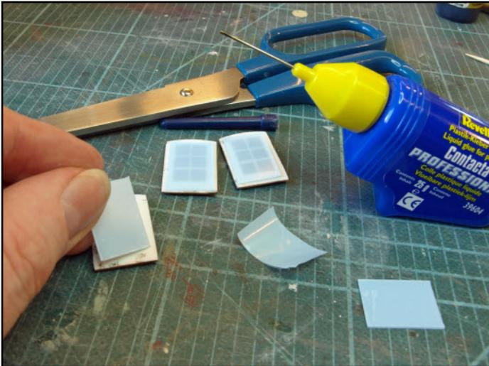
Mit einer Schere werden passende Vivakteilchen ausgeschnitten, die Schutzfolie wird einseitig entfernt und die „Verglasung“ mit sparsamer Klebstoffverwendung auf die Fensterbauteile aufgeklebt.
