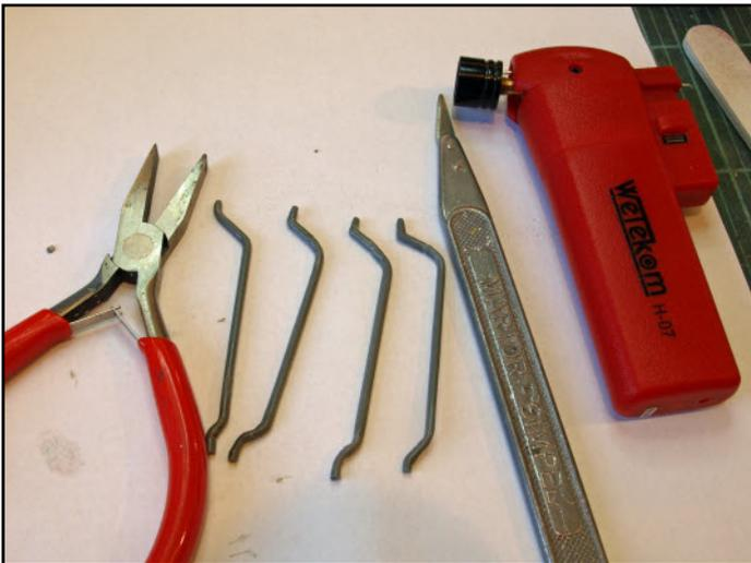
Für die Fallrohre würde sich  $\varnothing$  2,00mm Aluminiumdraht anbieten. Da wir unseren aber nicht gefunden haben, kamen doch die Addie-Fallrohre zum Einsatz. Mit etwas Wärme (Vorsicht, nicht zu viel!) könne die Fallrohre entsprechend dem Dachüberstand und dem Sockel angepasst werden.
