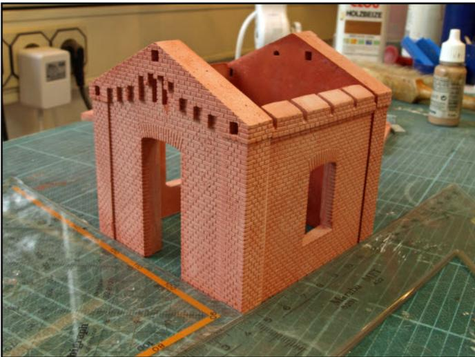
Nach dem alle vier Wände verklebt, aber noch nicht ausgehärtet sind, kann z. Bsp. mit zwei Dreiecken die Rechtwinkligkeit korregiert werden.
