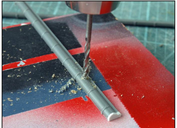
Bei diesen Rinnenböden wird überstehendes Material abgeknabbert und verschliffen. Mit einem 2mm Bohrer wird ein Loch für die Fallrohre gebohrt. Die Addie-Fallrohre sind 2,2mm stark, müssen also entweder angespitzt werden oder das Loch etwas aufgerieben.
